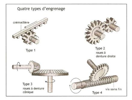
Un engrenage est un mécanisme composé de deux roues dentées mobiles autour d'axes de position relative invariable.
